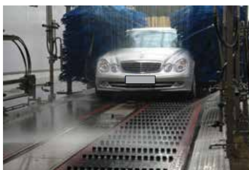
Tunnel di lavaggio esterno per auto con due catene serie 6990 e spintori T2
